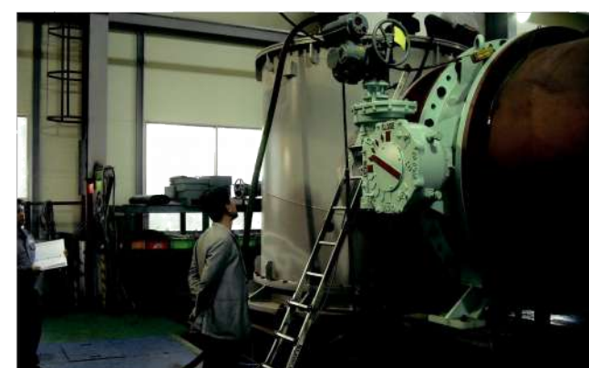
Vận hành thử nghiệm bơm chìm dạng trục
